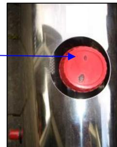
Nach jedem **Flaschenwechsel** und vor Inbetriebnahme muss die hergestellte Anschlussverbindung (Flaschenabsperrventil/ Druckregleinrichtung) auf **Dichtheit** kontrolliert werden. Die Dichtheitskontrolle ist z. B. mit schaubildenden Mitteln unter Betriebsdruck (→ geöffnetes Flaschenabsperrventil und geschlossene Mehrfachstellgeräte (Regelknöpfe) des Gasgerätes) durchzuführen.
